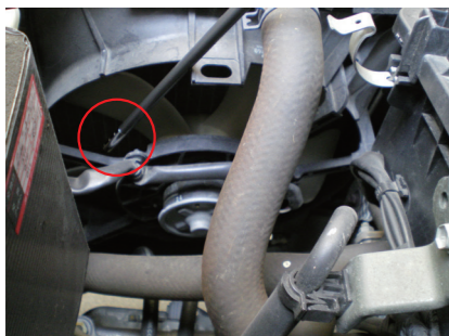
エンジンルーム内ラジエーター部のフィンへの平行にエアブロー
