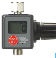
E-RG02 使用圧力 0~0.5MPa エア入口G1/4 エア出口G1/4
