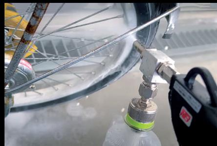
市販のペットボトルを容器として重曹を研磨材としてドライ&ウェット（重曹1に対し水10）の2wayのサビ、油、鉄粉の除去作業が出来ます。
